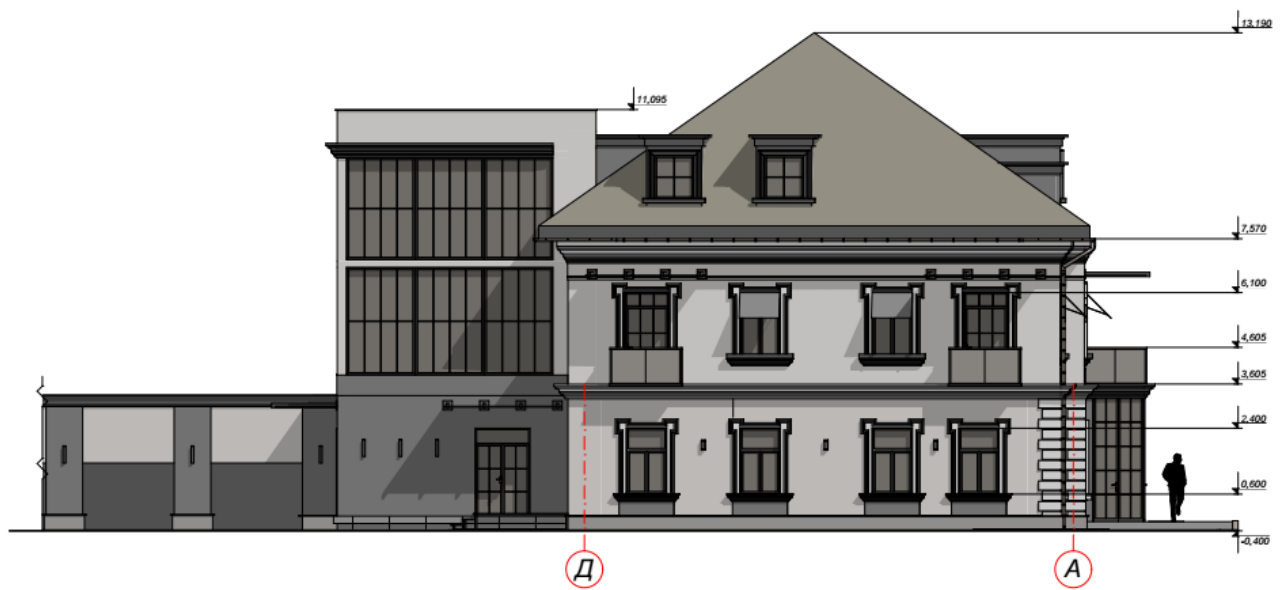
Проект ревіталізації родинного будинку С.Скарбека в м.Миколаєві Львівської області та пристосування його під готель з кафе-рестораном. Фасади М 1:100.
